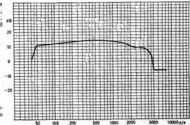
Fig. 20. Frekvenskurva för nälmikrofon Luxor , 0,5 Mohm belastning. Provska enligt fig. 9 (78 v/m).
