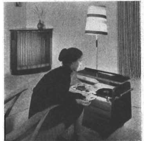
Fig. 6. Siemens' nya »Kammermusikgerät». I bakgrunden högtalarenheten, i förgrunden avspelningsenheten med bandspelare, gram-mofon-, UKV-enhet, samt hi-fi-förstärkare.
