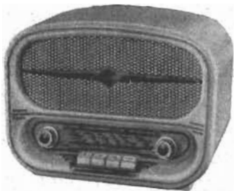
Fig. 3. Liten tysk rundradiomottagare för LV, MV och UKV, ferritantenn, tryckknappar för områdesomkoppling, sex rör. Pris: 200 DM!
