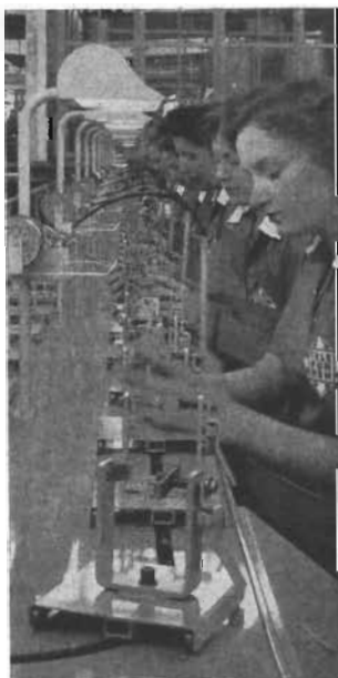
Fig. 1. På Düsseldorf-utställningen demonstrerade Telefunken hur tillverkning av UKV-enheter på löpande band går till.
