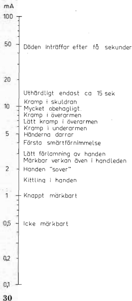
Fig. 1. Strömstyrkan genom människokroppen ger upphov till varierande symtom beroende på strömmens styrka. De angivna symtomen avser förhållandena vid växelström av teknisk frekvens.
