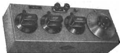
Dekadkondensator med luftkondensator
