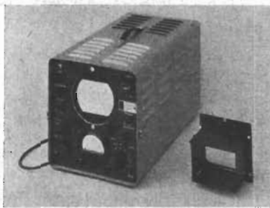
Fig. 10. Mätanordning för uppmätning av fältstyrka och för provning av TV-antenninstallationer. Består av en komplett TV-mottagare, ev. spökbilder studeras på bildskärmen.
