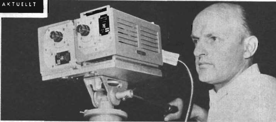
Fig. 1. Genom att montera två special-TV-kameror sida vid sida kan man lätt ordna med stereoskopisk upptagning av TV-bilder.
