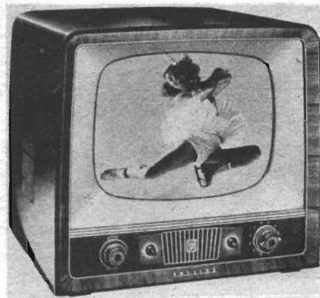
Fig. 1. TV-mottagare »Tizian» från Deutsche Philips GmbH. Innehåller 14 rör exklusive bildrör och högspänningsdiod. Blockschemat i fig. 2.
