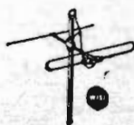
W 260. Vikt dipol med reflektor. Förstärkning 3 dB. Riktverkan 3,5: 1.
