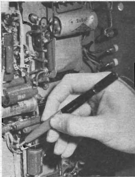
Fig. 1. Glimlampsoscillator inmonterad i en kulspetspenna utgör ett behändigt serviceinstrument!
