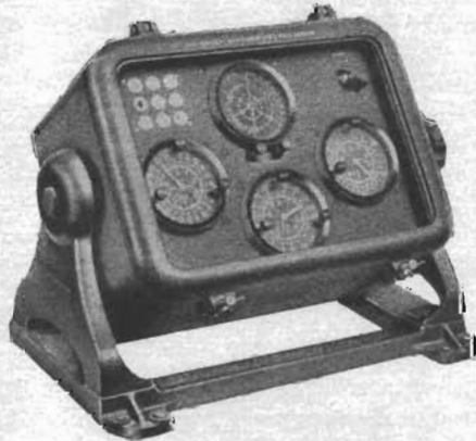
Fig. 3. Decca-mottagare med decometrar indikerande det inbördes fasläget mellan de radiovågor, som infaller från Decca-sändarna.
