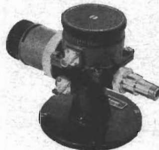
Fig. 1. Ny typ av ståendevägmätare bestående av koaxialkablöfgrenning av T-typ.
