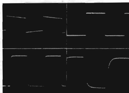
Fig. 5. Prov med kantvåg för frekvenserna 20 Hz (överst t.v.), 1000 Hz (överst t.h.), 10 000 Hz (nederst t.v.) och 50 000 Hz.
