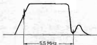
Fig. 19. Frekvenskurvan för TV-mottagaren skall ha i stort sett denna form. Avståndet mellan läget för bild och ljudbärvåg skall vara 5,5 MHz. Lämpliga frekvensmarkeringar erhålles om 5,5 MHz-kristalloscillatorn får anslutas parallellt med markeringsoscillatorn.
