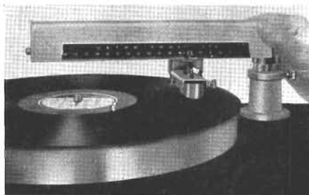
Fig. 1. Ny typ av tonarm som inte är behäftad med vinkelfel.
