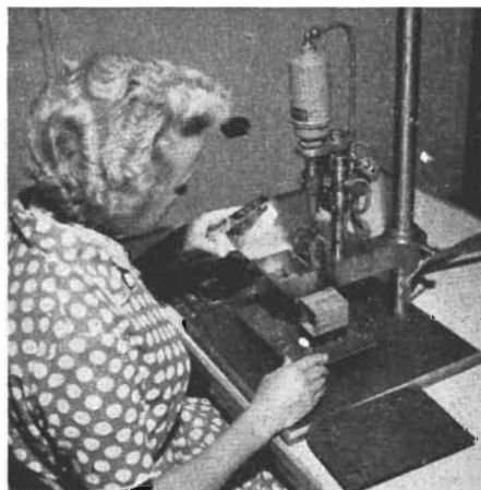
Fig. 1. Motstånden till den tryckta ledningsplattan monteras med hjälp av denna specialmaskin, som ordnar motstånden, klipper av fäständerna till lämplig längd, böjer och klämmer fast fäständerna i de därför avsedda hålen i plattan.
