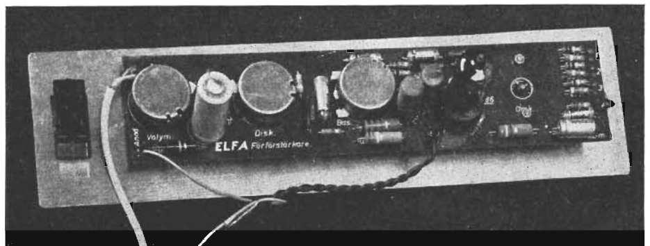
Fig. 4. Så här ser den färdiga förstärkaren ut. Nätströmbrytaren längst till vänster är avsedd att ersätta nätströmbrytaren i effektförstärkaren.
