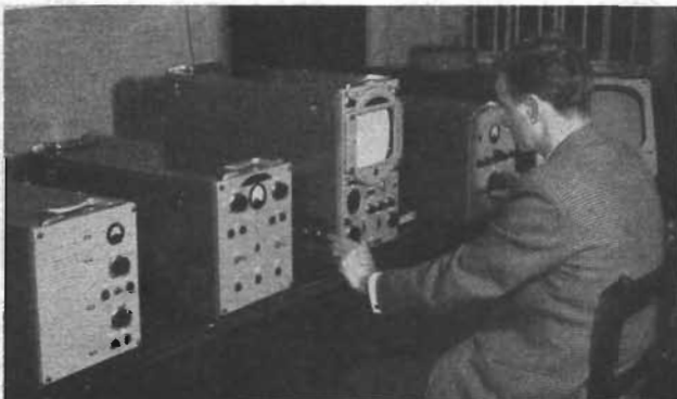
Fig. 3. Här sker övervakning av bildspänningen från den på teleskopet i fig. 4 anbringade TV-utrustningen för avsökning av den uppfångade bilden.
