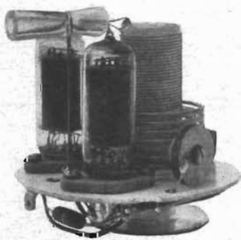
Fig. 5. Drivsystem för större typ av jonofon bestyckad med 2 st. EL84.
