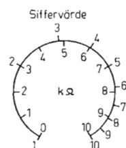
Fig. 3. Potentiometrar P_1 och P_2 i fig. 2 skall ha siffrvärden i logaritmisk skala.
