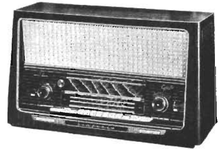
Fig. 1. Rundradiomottagare »Sinfonia» från Graetz AG, försedd med ljudkompressor för uppnående av »rymdklang». Ljudöppning skymtar på apparatens högra sidostycke.
