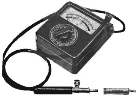
Fig. 6. Voltmeter för frekvenserna från 30 Hz upp till 450 MHz. Tillverkare: Siemens & Halske AG. Svensk representant: Svenska AB Siemens.
