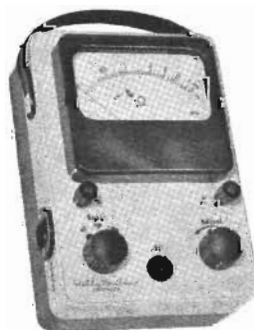
Fig. 4. Nätansluten »lågohmmeter» i robust utförande av danskt fabrikat. Mätområde: 0,05—3000 ohm. Svensk representant: Elektriska Instrument AB Elit , Stockholm.
