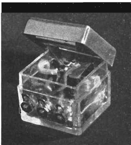
Fig. 1. Den färdiga likspänningsomvandlaren, monterad i en liten plexiglaslåda. Ytermått: 22x22x20 mm.
