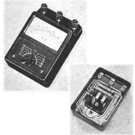
Fig. 1. Universalinstrument med vridjärnsinstrument i stället för vridspoleinstrument, går utan likriktare även för växelström. Tillverkare: Siemens & Halske AG. Svensk representant: Svenska AB Siemens , Stockholm.
