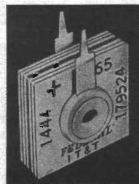
Fig. 7. I USA tillverkas numera i allt mera ökad omfattning komponenter, speciellt tillverkade för användning i tryckta kretsar. Här en selenlikriktare.
