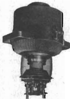
Fig. 1. Rör TBW 12/25 från Philips.
