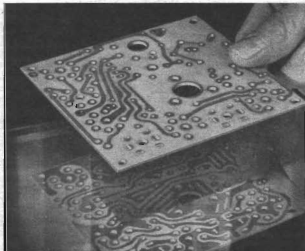
Fig. 2. Isolerande platta för tryckt ledningsdragnings med kopparfolier på plattans båda sidor. Genom speciell teknik erhålles enkla förbindningar mellan ledningar på resp. sidor av plattan. Fabrikat: General Electric, USA.
