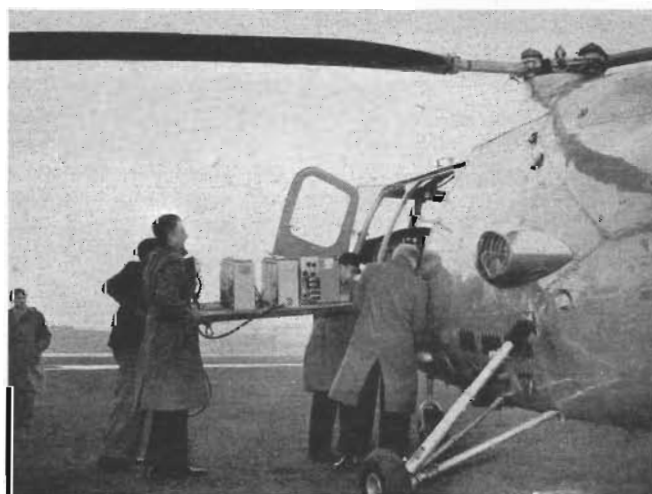
Här sker inlastning av TV-utrustningen i helikoptern. Utrustningen väger endast ca 200 kg; den drivs från helikopterns elektriska system.
