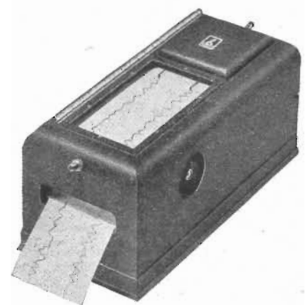
Fig. 8. Bläckskrivare av amerikanskt fabrikat, Brush Instruments, för högre skrivhastighet (0—100 Hz). 2 registreringskanaler. Svensk representant: Ingenjörfirma M Stenhardt, Vällingby.
