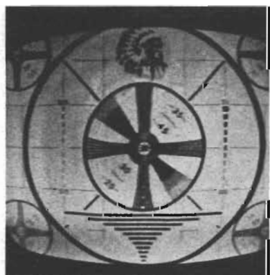
Fig. 28. Att god linearitet erhålles i TV-mottagaren visar denna bild. Foto: M Lundqvist, Södertälje.
