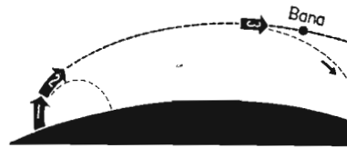
Fig. 4. Satelliten utskjutes i tre etapper. Jfr fig. 1. Sluthastigheten hos satelliten: ca 8000 m/s.
