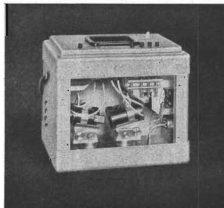
Fig. 18. Ljusstråleoscillograf med kvicksilverånglampa för registrering av fyra elektriska förlopp samtidigt. Fabrikat: Hartmann & Braun AG. Svensk representant: Ingenjörfirma Hugo Tillquist, Stockholm.
