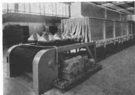
Fig. 6. Ugn för upphettning av bildrören efter anbringandet av det ljuskänsliga skiktet och aluminiumskiktet.
