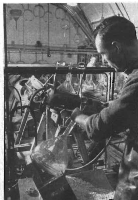
Fig. 4. Bildrören rengöres först i roterande skakmaskiner. Röret fylls med krossad marmor, som vid skakningen river bort eventuella föroreningar. Bildrören sköljes därefter med destillerat vatten.
