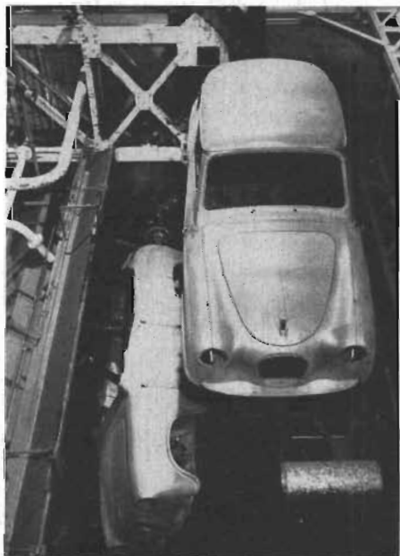
Fig. 8. Austins »Rotodip-anläggningar», vardera med kapaciteten 22 chassier per timma, utför automatisk rengöring, rostskyddsbehandling och grundstrykning av bilchassierna.
