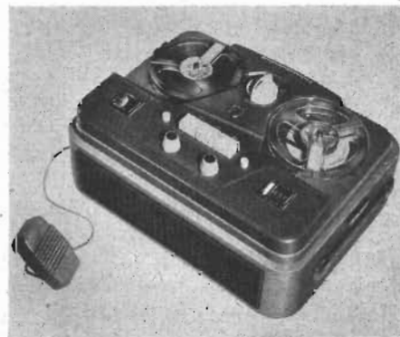
Fig. 13. Den nya »mätbandspelaren» från Telefunken , typ M 5, kan användas för upptagning och magasinering av mätvärden.
