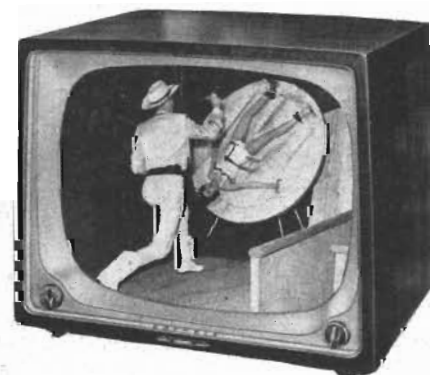
Fig. 2. TV-mottagare med 61 cm bildrör från Grundig. Endast två kontroller tillgängliga på framsidan, varför yttermåtten endast obetydligt överstiger motsvarande mått för mottagare med 53 cm bildrör.
