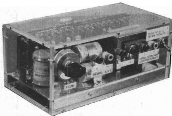
Fig. 2. Demonstrationsapparaten i sitt plexiglashölje. På grund av risken för bruminstrålning från närbelägna växelströmsnät är det lämpligare att bygga förstärkaren i helskärmat utförande.
