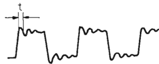
Fig. 3. Denna vågform hos den förstärkta kantvågen tyder på resonansfenomen i förstärkaren vid frekvensen f_r = 1/2t .
