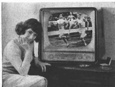
Fig. 10. I de nya tyska TV-mottagarna dominerar bildröret på framsidan, varför det är mycket liten plats kvar för en fronthögtalare. I denna mottagare från Graetz, »Burggraf», har man en smal ljudspringa, där ett speciellt utformat exponentialhorn utmynnar, se fig. 11.
