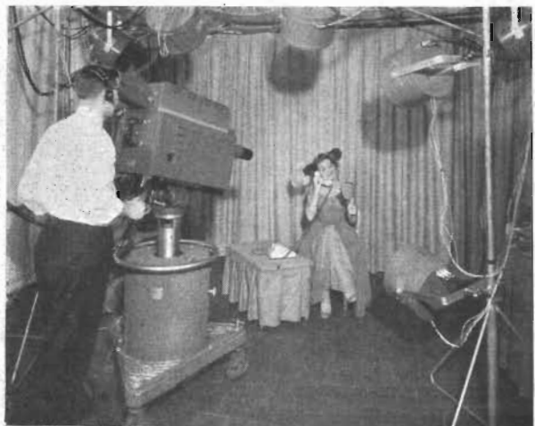
Fig. 7. TV-studio med färg-TV-utrustning enligt Du Monts »Vitascan-system». Scenen upplyses av korta ljuspulser som utsändas under släcktiden vid bildväxlingen.
