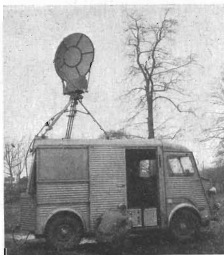
Fig. 4. Detta är den reportagelänkutrustning som Radiotjänst använder i TV-länkförbindelsen Stockholm—Göteborg.
