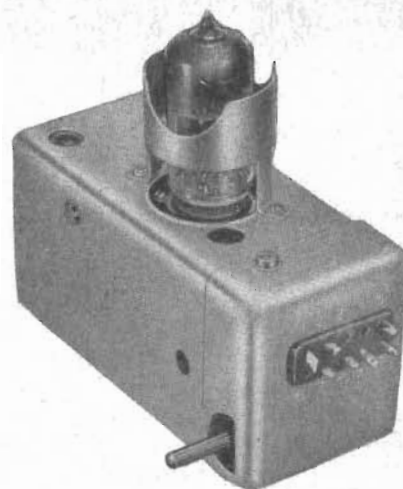
Fig. 4. Telefunken's UKV-enhet typ O21 för FM-bandet.
