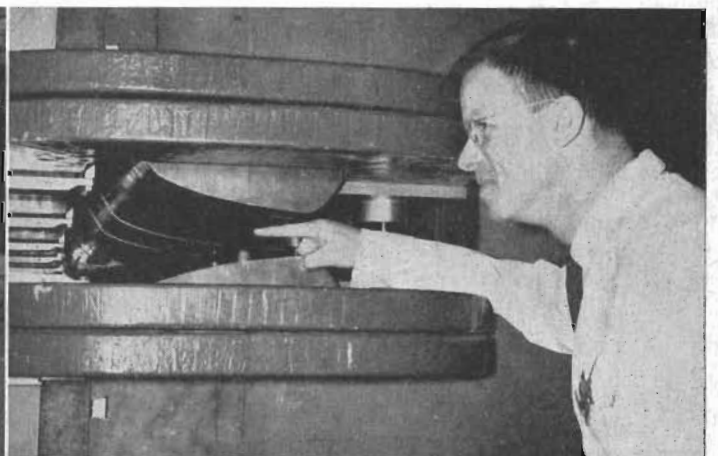
En av de svenska forskarna vid CERN, civilingenjör Jörgen Nilsson, pekar ut var protonstrålen kommer att gå fram mellan magnetpolerna. Men naturligtvis inuti det elliptiska vakuumröret.
