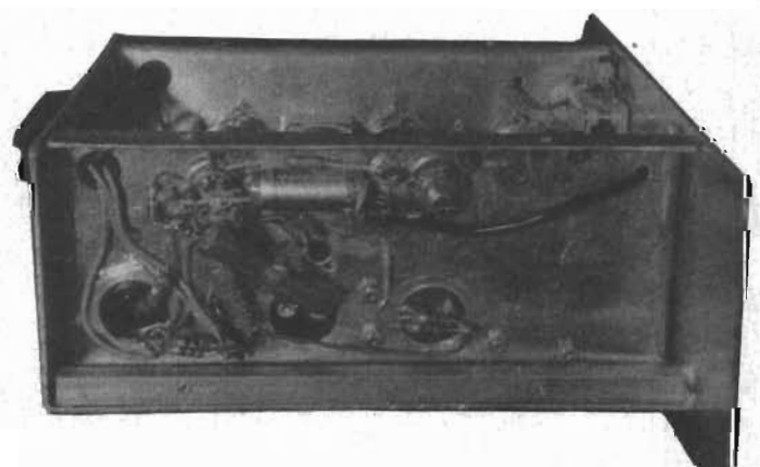
Fig. 9. Chassi 3 färdigkopplat, sett underifrån. Observera att hål upptagits på ett par ställen för att man skall komma åt att trimma MF1 och MF2.
