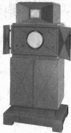
En kombinerad televisions- och rundradiomottagare av år 1932. Överst syns »bildfönstret» och därunder högtalaröppningen.
