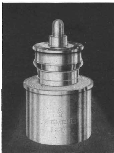
Fig. 6. 12 kW sändartriöd för ultrakortvåg, typ RS 1011 L från Siemens och Halske. Triöden är avsedd för luftkylning.
