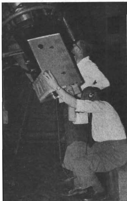
Teleskopobservatören och TV-observatören är här i färd med att justera in bilden av Mars inom fältet för TV-kameran. Fotot taget i Lamont-Hussey Observatory , Bloemfontein i Sydafrika.
