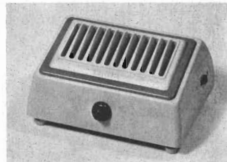
Fig. 3. Sidoapparaten innehåller en högtalare/mikrofon och två omkopplare, en för anrop till huvudapparaten samt en sekretessomkopplare.
