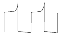
Fig. 10. Utgångsspänningen från cantvågstill-satsen har detta utseende.
