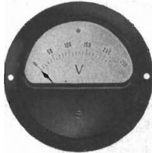
Vridspoleinstrument typ D 50/63
