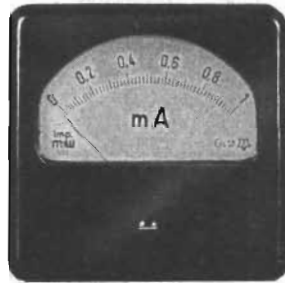
Vridspoleinstrument typ DQ-45
