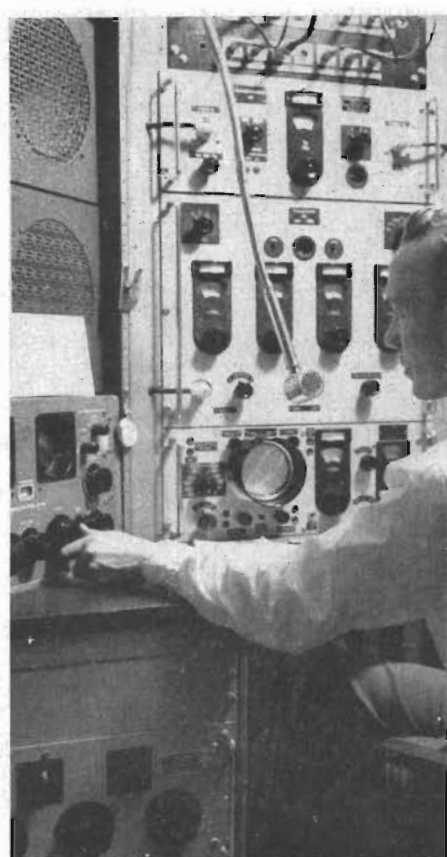
En annan av mätplatserna på kontrollstationen. Här tillämpas en princip för frekvensbestämningen enligt blockschemat i fig. 2. Frekvensdekadgenerators ( Schomandl ) synkroniserad med 100 kHz-signalspänningen från frekvensnormalanläggningen möjliggör inställning av godtycklig frekvens som jämföres med inkommande signalens frekvens. På oscilloskopet nedst ser man en Lissajous figur som visar att 0-svängning med den undersökta signalen uppnåtts.
