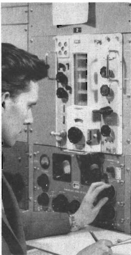
Detta är ett par av de mottagare som användes på kontrollstationen. Överst en långvägsmottagare av fabrikat Murphy som täcker frekvensområdet 15 kHz—700 kHz. Under denna en Hammarlund »SB-600».
