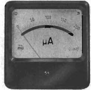
Vridspoleinstrument typ DQ-96
