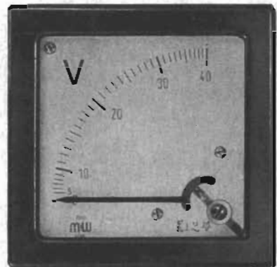
Vridjärnsinstrument typ EHQ-96
