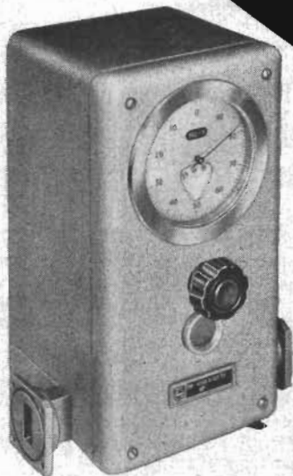
Direktvisande vägmeter PP 4290 X
