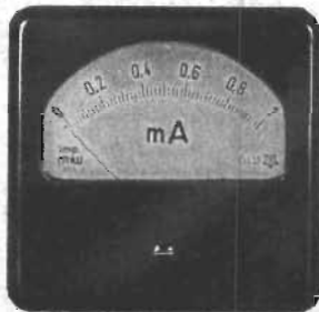
Vridspoleinstrument typ DQ-45
