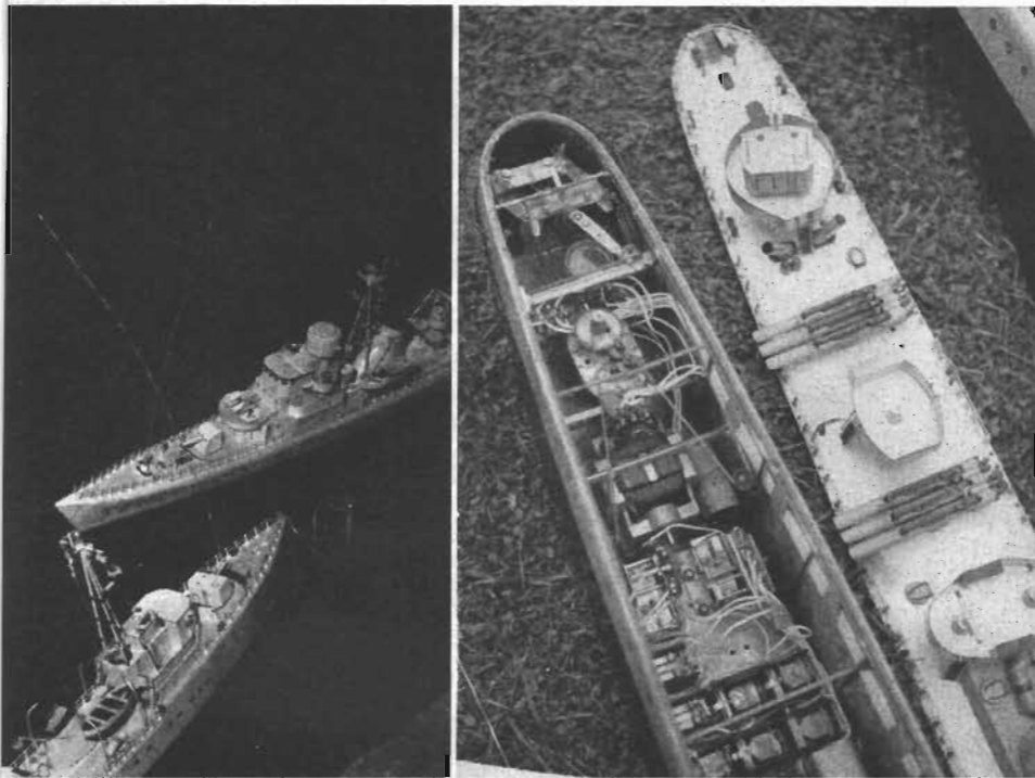
Fig 4 Dessa modellbåtar är utrustade med anordning för fjärrkontroll av kurs och fart, kanonernas inriktning, tändning och släckning av belysningen m.m.
