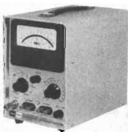
Modell 203 med 25 mätområden \pm 100 \mu\text{V} —1000 V \pm 100 \mu\text{A} —0,1 A
