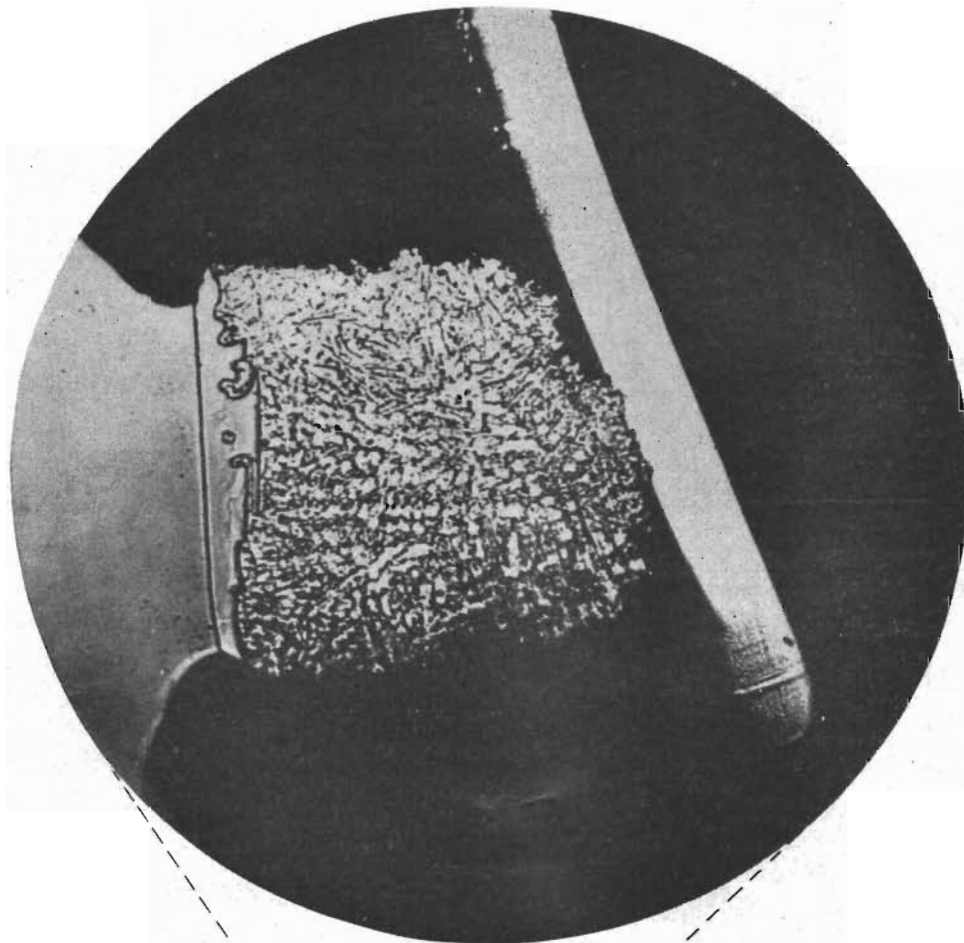
Oretuscherat mikrofotografi av skiktregionen i en Hughes standard kisel skiktdiod.
