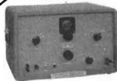
202A — för servo-, vibrations-, medicinska och andra mycket lågfrekventa mätningar. 0,008 — 1200 Hz. Uteffekt 20 mW/10 V sinus-, triangel- och fyrkantvåg.
