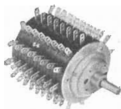
Byggbara omkopplare för upp till 8 A brytström — — isolation 0.5 \times 10^{12} ohm — övergångsmotstånd c:a 2 mohm — spänningsprovad för 2000 V.
