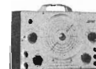
242×166×132 mm. 150 KC—300 MC. 6 band: A, B, C, D, E, F. Tolerans ±1%. Utsp. 0—0,1 Volt. CV el. mod. 800 p/s. Anslutning f. yttre modulation. Nätanslutning 220 V. AC. Vikt 2,2 kg. Lätt transportabel, stabil och oöm. Pris Kr. 165.—
