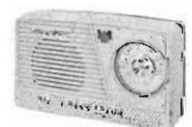
115×62×30 mm. 6 transistorer, 1 Ge-diod, 1 termistor. Frekv. 535—1605 KC. Ferritantenn. 2,5" PM högtalare. Uteff.: 50 mW. Höglanspoilerad front. I denna högklassiga apparat är de i andra transistorapp. så besvärande temp-drifterna helt eliminerade medelst termistorn. Pris Kr. 145.— inkl. batteri
