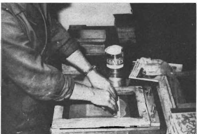
Silk-screen-ramen med sin finmaskiga silkeduk, preparerad med det önskade ledningsmönstret, fälles ner. Med hjälp av en gummikantförsedd spackel pressas täckfärg genom silkedukens fria partier och därmed täcks det blivande ledningsnätet på plattan med färg.
