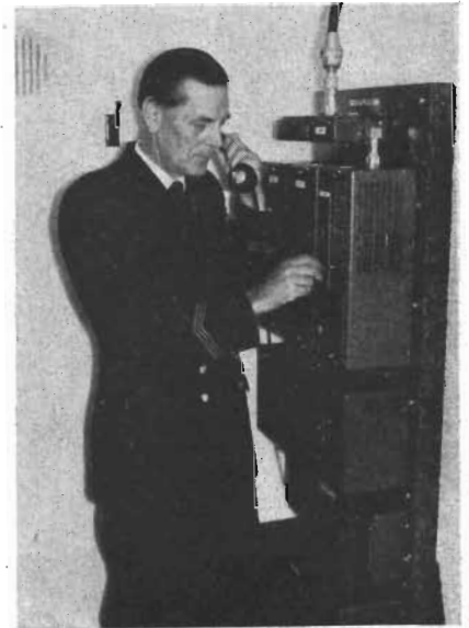
100 W UKV-sändaren, levererad av Telefunken , för radioförbindelse med Trelleborg och Sassnitz ombord på »Trelleborg», tar inte stor plats.
