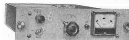
Fig 4 Ny typ av anläggning för diversitetsmottagning med en mottagare. Kopplar om mellan tre antenner. Bestyckad med transistorer.
