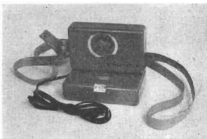
Fig 3 Transistoralarmmottagare av dubbelsupertyp för 80 MHz-området. Känslighet: 1 \mu V från antennen ger larmutlösning. Vikt: 0,8 kg. Foto: Telefunken.
