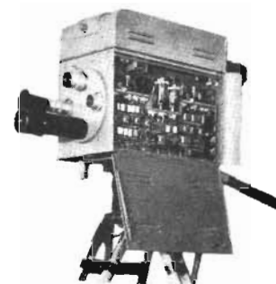
Rysk televisionskamera med objektivrevolver och elektronisk sökare. Rörbestyckningen förefaller vara en smula gammalmodig.
