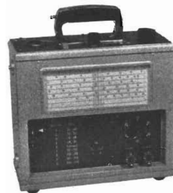
Störsäkningsapparat och samtidigt antennenprovningsapparat för 8 frekvensområden mellan 30 och 230 MHz för Deutsche Post i Östtyskland. Apparaten är batterimatad och väger endast 4,5 kg. Tillverkare: VEB Funk-Werk, Dresden.
