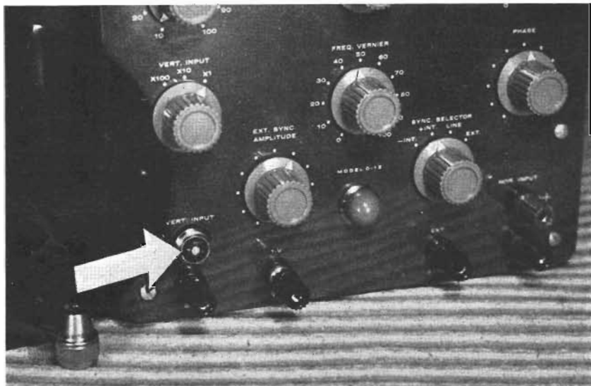
Fig 3 På känsliga oscilloskop är det klokt att ersätta den varma vertikala ingångsklämman med en mikrofonkontakt (vid pilen).
