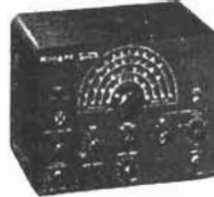
Y 123 TV-Fm Sveg- generator
