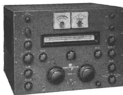
En amerikansk ESB-anläggning från Cosmos Industries Inc., i USA. Innehåller en sändare för 1 kW och mottagare med känsligheten 1 μV vid 6 dB signalstörningsförhållande. Överför LF 200—3100 Hz och har frekvensdrift mindre än 100 Hz. Apparaten har två frekvensskalor, en för sändaren och en för mottagaren, som kan avstämmas oberoende av varandra. I mottagaren kan man välja mellan övre eller lägre sidband, beat-oscillatorn kristallkontrollerad.
