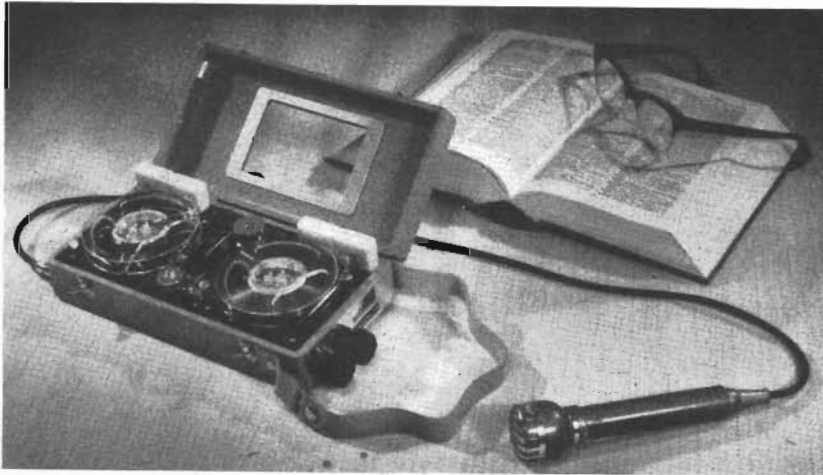
Miniatyrbandspelaren »Stellavox SM4». Manöverorganen sitter utanpå så apparaten kan köras med stängt lock. De fyra stora »tryckknapparna» är batterier. Apparaten tillverkas av Firma Elektromesstechnik W Franz, Lahr, Schwarzwald.
