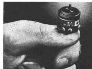
Potentiometer av precisionstyp, 1 W, trådlindad, 1500 varv, linjär resistanskurva. Diameter 19 mm(l). Tillverkare: L.E.G.P.A.
