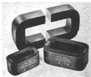
Fig 8 Silicore-kärnor i C-form, lämpliga bl.a. för närttransformatorer. Minskar dimensionerna för dessa till hälften jämfört med transformatorer med ordinar plåtklipp. Tillverkare: Isolectra, Montreuil.
