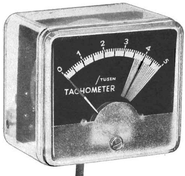
Den färdiga takometern i sitt plexiglashölje. »Farligt» varvtalsområde markeras på skalan med ett vitt fält. Varvtalet anges i tusental varv.
