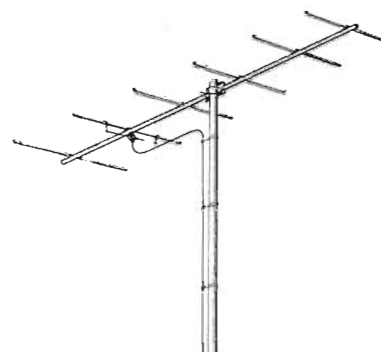
806 Takantenn täckande 2 kanaler inom Band III.
