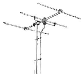
6303 Takantenn för 1 kanal inom Band I.
