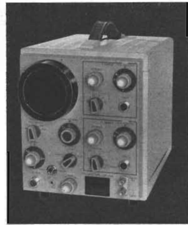
CD 1014 DUBBELSTRÅLE-OSCILLOSKOP Två kanoner i 3 1/2" katodstrålerör. DC—5 Mc/s (3 dB), 100 mV/cm, Y-först. Förförstärkare i en Y-kanal ger 1 mV/cm AC. Svep 1 \mu sek.—1 sek./cm; 10 ggr X-exp.
