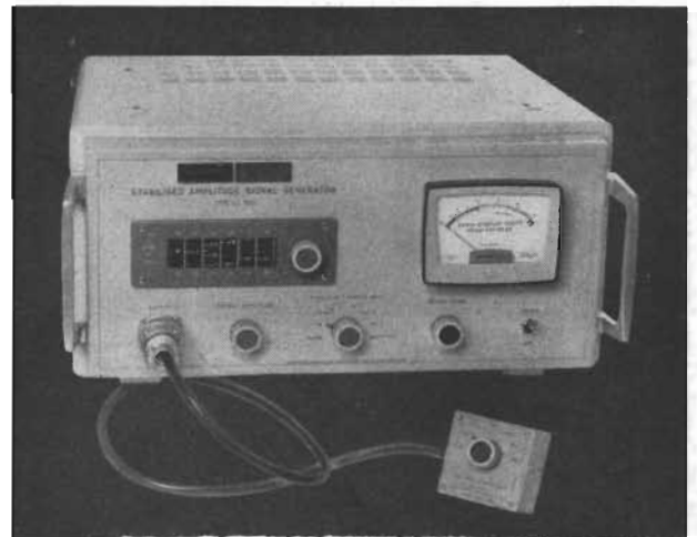
DO 905 SIGNALGENERATOR, stabiliserad amplitud Kontinuerlig inställning av frekvens inom området 350 kc/s—50 Mc/s i 6 om- råden. Konstant amplitud, 52 ohm utgång.
