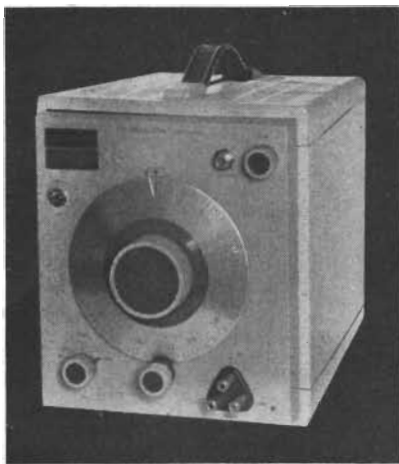
CO 1004 LÅG FREKVENSSOSCILLATOR 10 c/s—1 Mc/s i fem områden. Utmärkt amplitud och frekvensstabilitet. Två utgångar, 0° och 180°. Utspänning 20 V i belastning över 20 k ohm. 10 V över 600 ohm.
