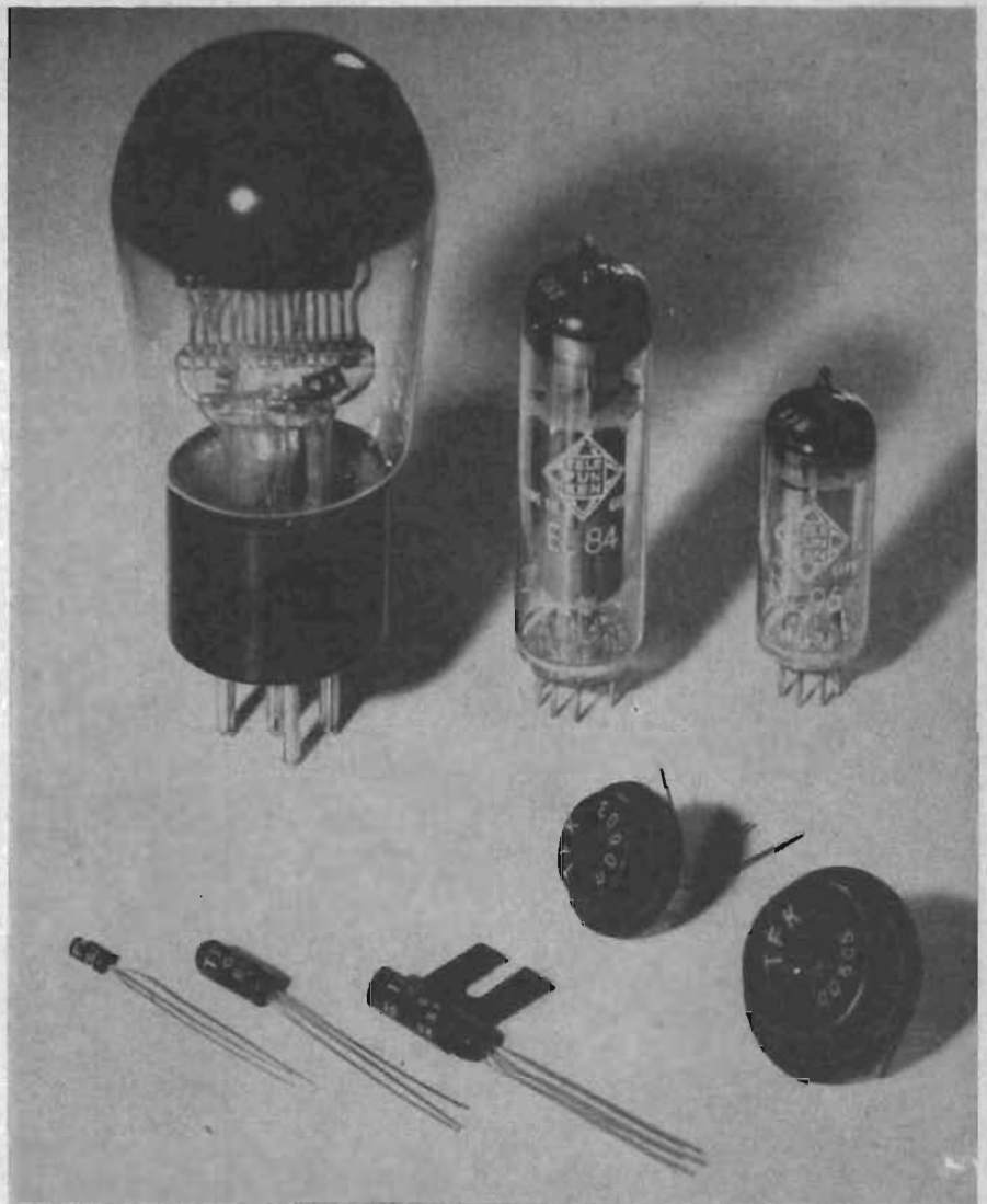
Denna bild visar med all önskvärd tydlighet de små dimensionerna hos transistorerna i jämförelse med elektronröret. Främre raden längst t.v.: en HF-transistor, bakre raden t.v.: ett HF-rör av äldre typ. Främre raden t.h.: effekttransistorer för LF. Bakre raden i mitten: effektrör för LF.
