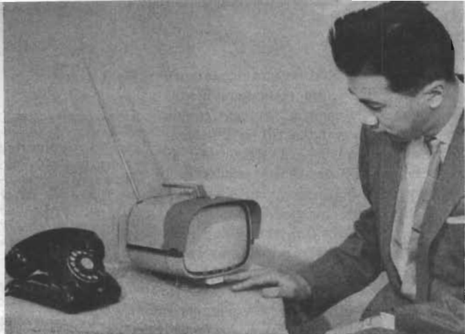
Den nya portabla TV-mottagaren från Sony Corporation som kommer på japanska marknaden i mars i år. Den innehåller 23 transistorer och 14 dioder och går på inbyggt 12 V batteri 3 Ah men kan också anslutas till växelströmskälla 100 V, 50—60 Hz. Effekttaget från nätet är endast 15 W! Motsvarande siffra för en vanlig TV-mottagare är 140 W. Ytterdimensioner: 16x20x22 cm. Vikt: 5,5 kg utan batterier, 6,5 kg med batterier.
