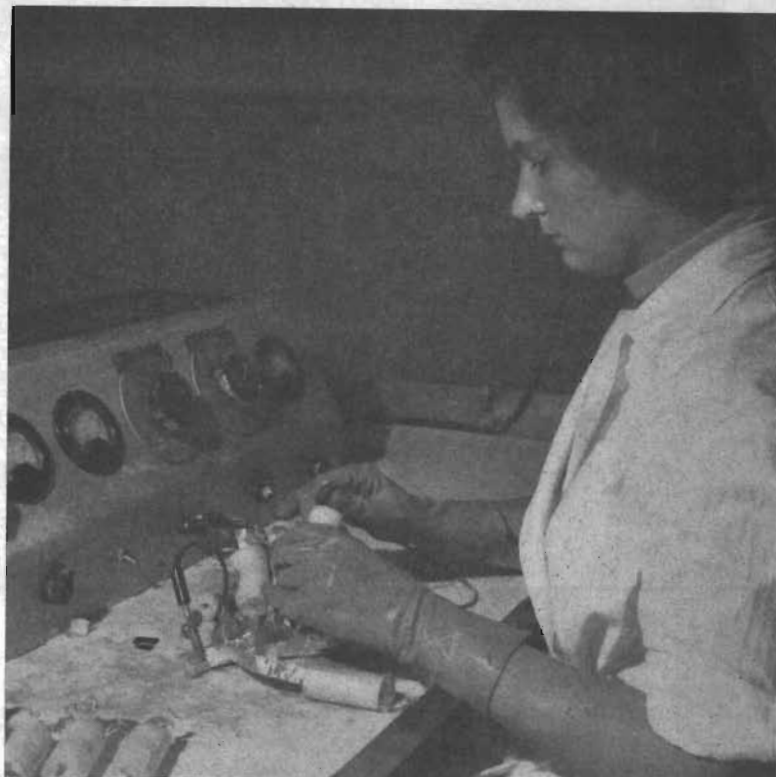
Framställningen av elektrolytkondensatorer bygger på elektrokemiska processer. Stora krav ställs på frihet från klorider hos de ingående materialen. Den största renlighet måste iakttagas under tillverkningen, hantering av elektrolytkondensatorer sker därför med gummihandskar. Här sker uppmätning av kapacitans och förlustfaktor på Rifas laboratorium.
