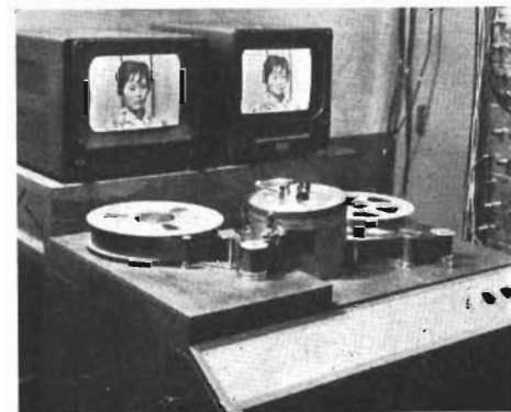
Detta är en experimentmodell för den japanska nya videobandspelaren. Mellan bandrullarna ser man här det cylindriska hölje, i vilket det roterande magnethuvudet arbetar. T.h. förstärkarstativ m.m.
