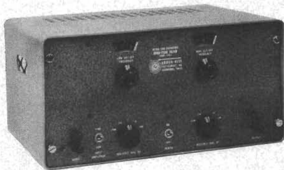
Bandpassfilter typ 330 0,02-2000 Hz eller 0,2-20 000 Hz
