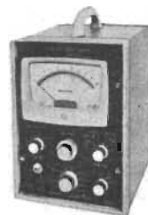
TSA 501 Frekvensmeter med direkt avläsning av »Rate-Meter» typ. 3 Hz till 300 kHz täckes i 10 områden.
