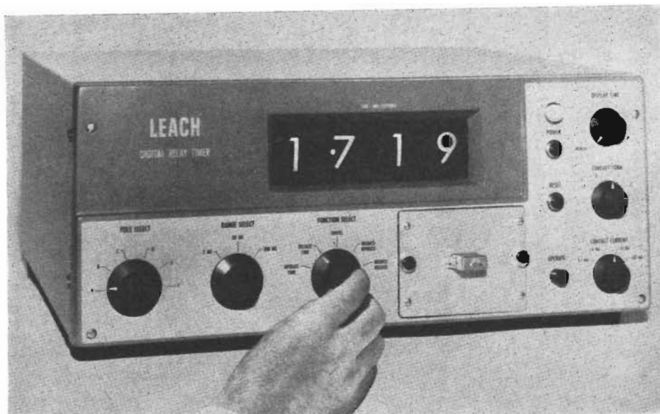
Exempel på ett digitalinstrument av speciellt slag utgör ett av Leach Corp. i USA tillverkat instrument, som kan användas för att prova reläer. Det anger direkt i siffror relätider, exempelvis tillslags- och frånslagstider, i ms. Instrumentet ersätter en relativt invecklad mätuppkoppling med oscilloskop.
